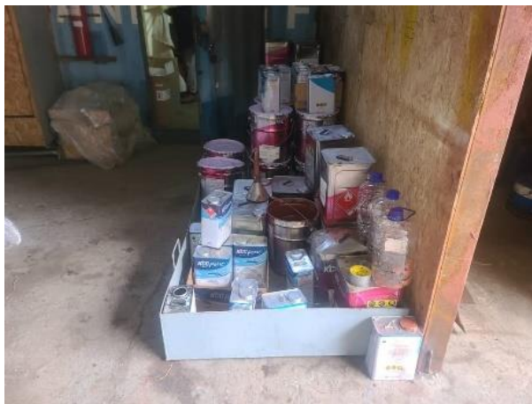
Фотография 26. Дополнительный защитный поддон для химикатов на участке хранения СП ZMEC (статус в январе 2023 г.)
